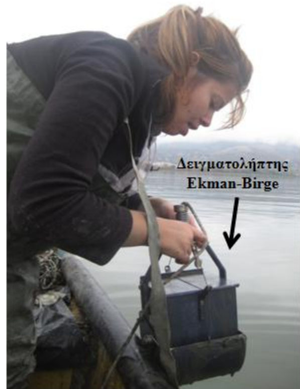
Εικόνα 3.3.2. Δειγματολήπτης τύπου Ekman-Birge. Figure 3.3.2 Sampler type Ekman-Birge.
