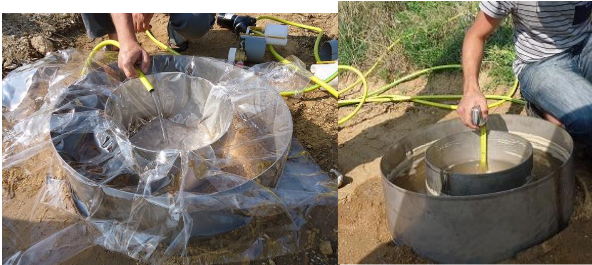
Εικόνα 28: Οι κύλινδροι γεμίζουν με νερό και αμέσως ξεκινάει η καταγραφή των μετρήσεων Picture 28: The cylinders are filled with water and immediately starts the recording of the measurements
