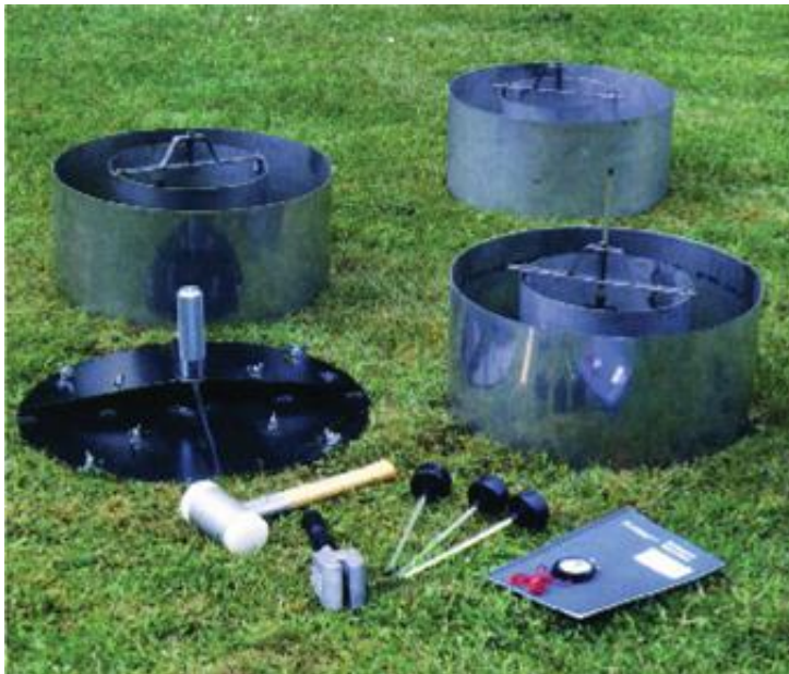
Εικόνα 24: Το διηθητόμετρο διπλού δακτυλίου
