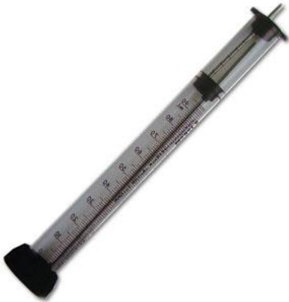
Εικόνα 12 : Δηθητόμετρο δίσκου (Πηγή: www.envco.co.nz ) Picture 12: Mini disk Infiltrometer (Source: www.envco.co.nz )
