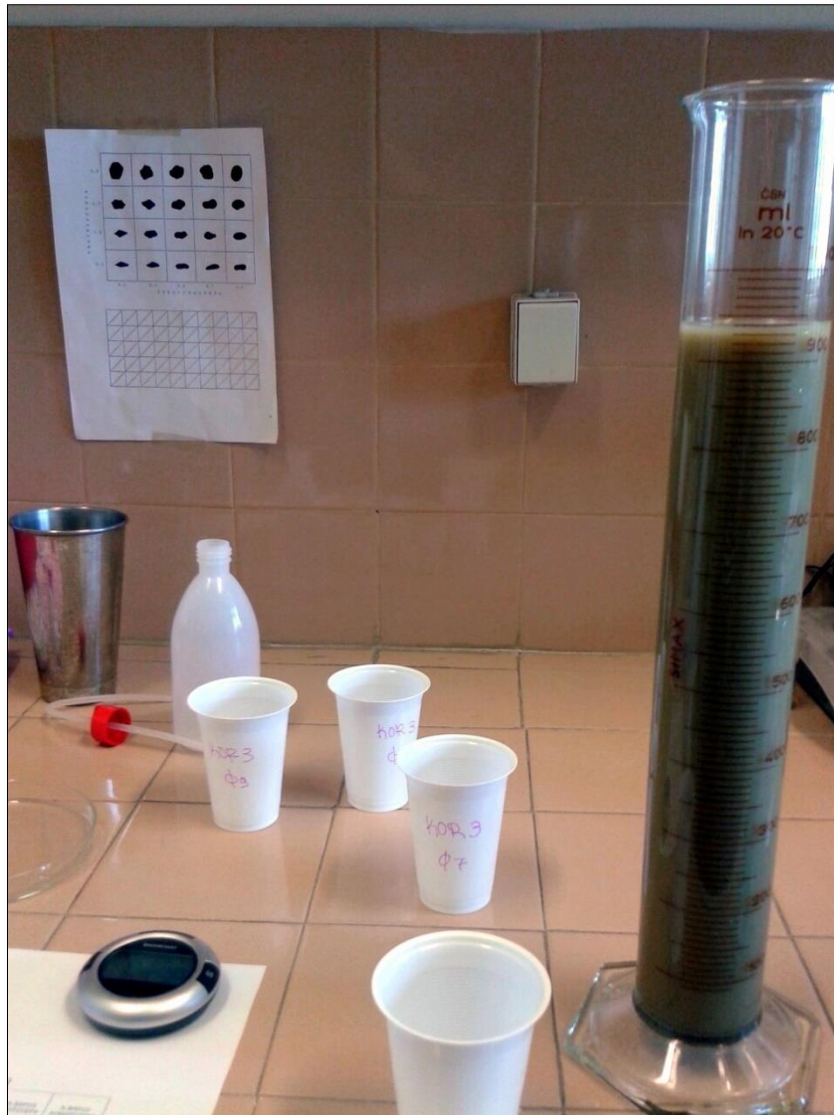
Σχήμα 23. Εφαρμογή της μεθόδου του σιφωνίου.
