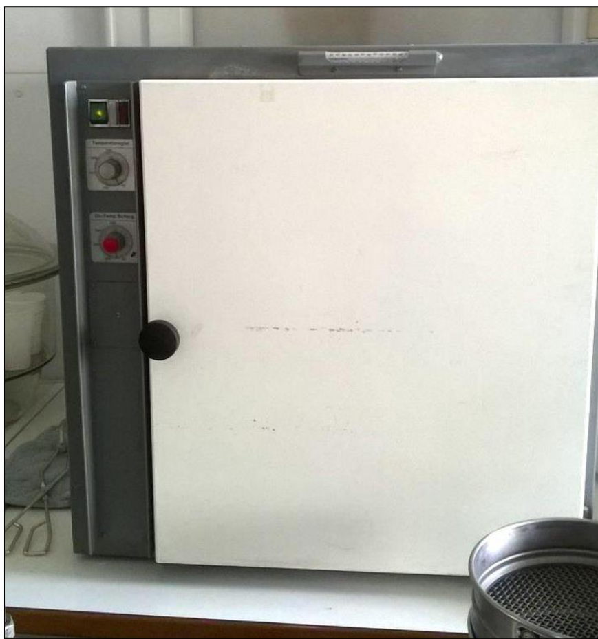
Σχήμα 18. Φούρνος ξήρανσης που χρησιμοποιήθηκε για να υπολογιστεί το βάρος επί τοις % της υγρασίας των ιζημάτων.
