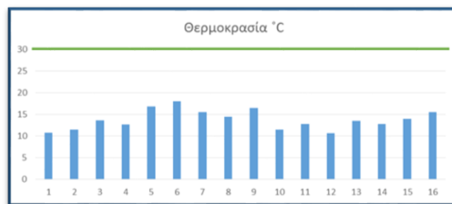
Εικόνα 5.3.2. Ετήσιος μέσος όρος των τιμών της θερμοκρασίας του νερού (T, °C) που καταγράφηκαν στους σταθμούς δειγματοληψίας της περιοχής αρμοδιότητας του Φ.Δ. το 2016. Η πράσινη γραμμή προσδιορίζει ανώτερο όριο που έχει καθοριστεί με το ΦΕΚ 1079/B/15-7-2010 σχετικά με τη διάθεση λυμάτων και υγρών αποβλήτων. Η αρίθμηση σταθμών είναι όπως Πίνακας 5.3.1.
